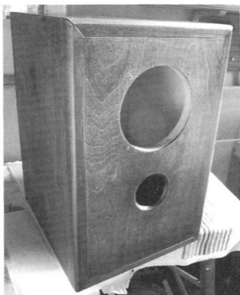
【写真16】 組み立てが完了したエンクロージャー
